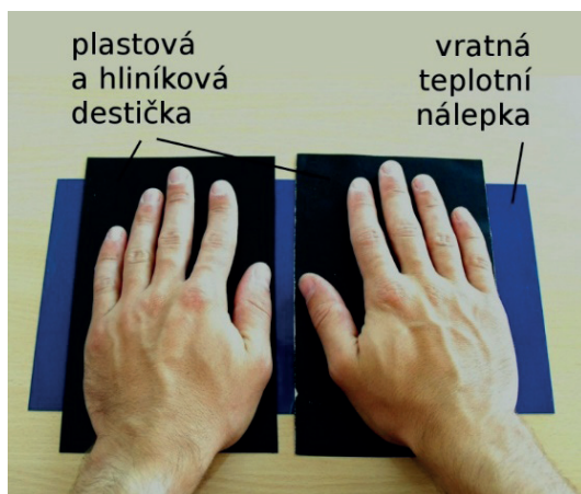
Obr. č. 2: Uspořádání experimentu – vedení tepla.*
