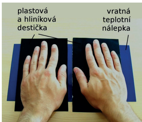
Obr. č. 2: Uspořádání experimentu – vedení tepla.*
