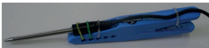
Obrázek 1. Teploměrné čidlo a jeho připevnění na kolíček a plechovku.
