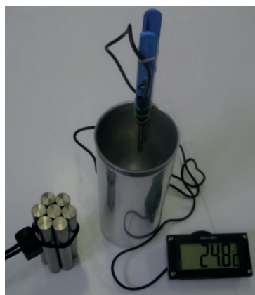
Obrázek 2. Uspořádání experimentu – vlevo jsou kovové tyčky sepnuty gumovým vláknem, zajištěny brzdíčkou a připraveny pro vhození do vody.
